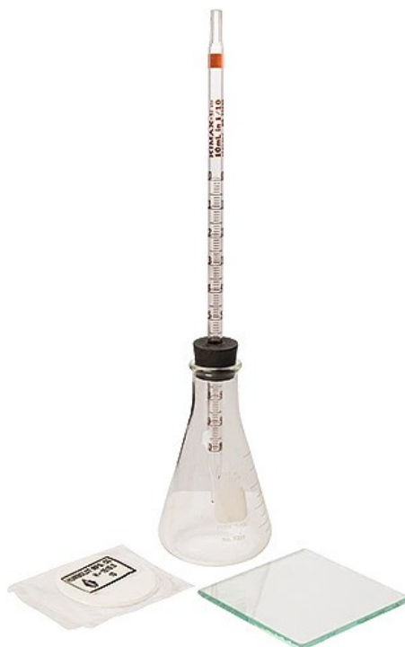
شکل ۱: نمای کلی از وسایل مورد استفاده در آزمون لکه
